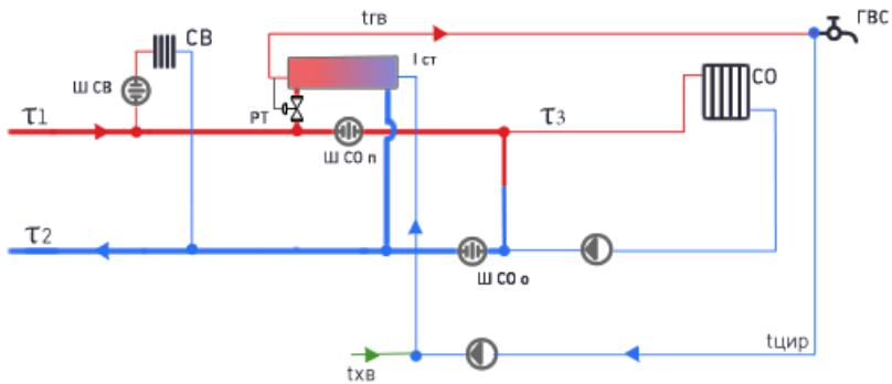
Потребитель с двухступенчатым смешанным подключением подогревателей ГВС и насосным присоединением СО (насос на обратном трубопроводе).
