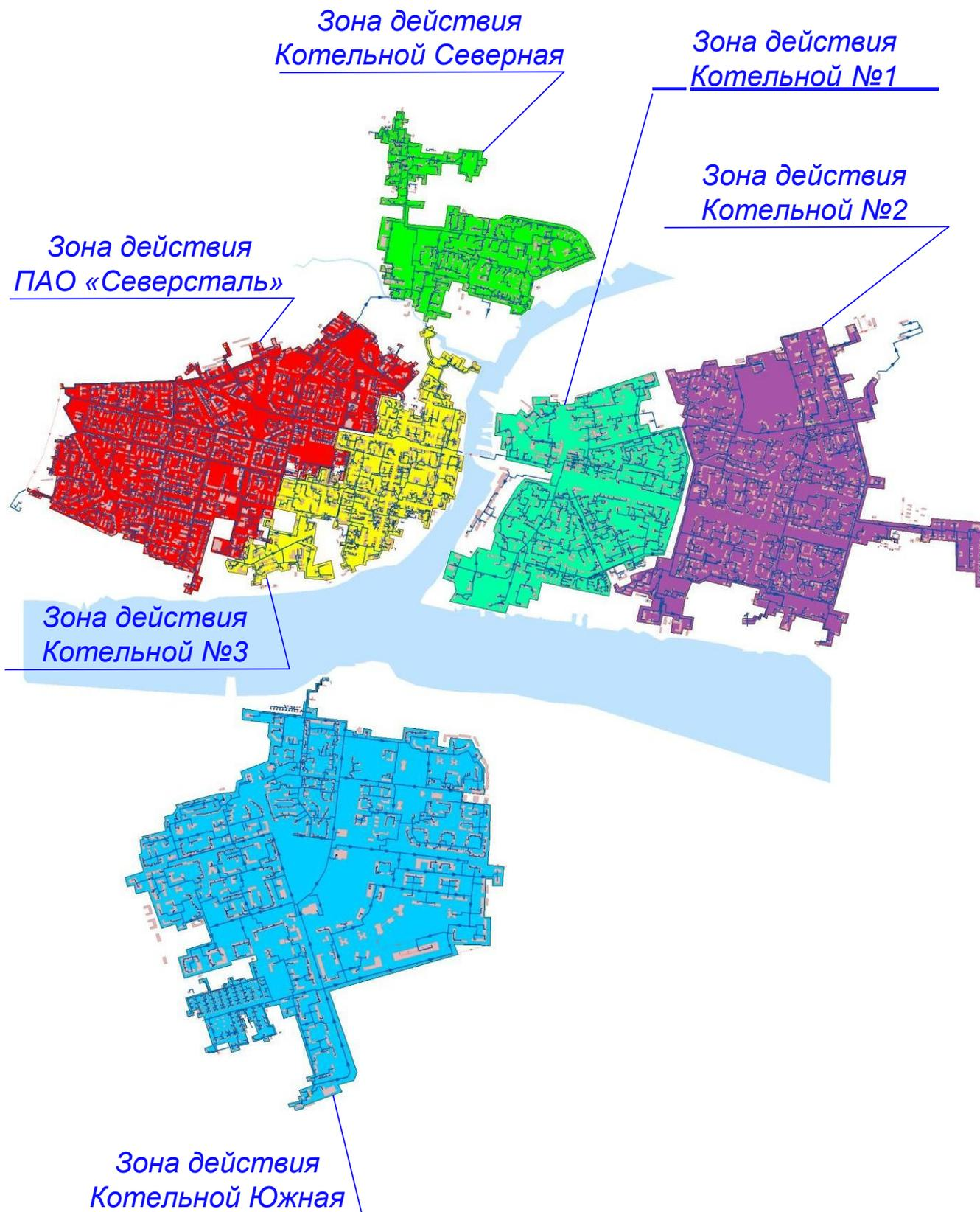
Рис. 4.2.3. Слой электронной модели системы теплоснабжения г. Череповца «Расчетные схемы тепловых сетей от источников теплоты в зонах их действия с привязкой к выданной ТОП - основе города»
