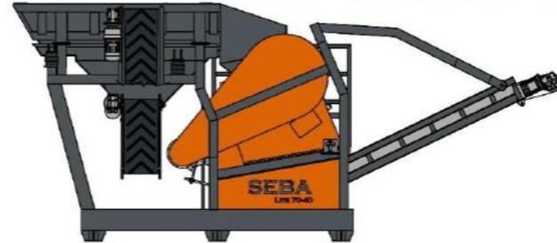
Дробилка LITE 70-40 VIBRANT подходит для измельчения бетона, кирпичного боя, строительных отходов, неликвидов ЖБИ, мрамора, керамики, песчаника, известняка и других хрупких инертных материалов с пределом прочности на сжатие до 130 МПа и максимальной крупностью до 325x325x500 мм.
