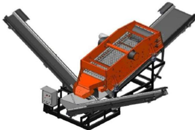
Грохот LITE SCREEN 312 предназначен для разделения сыпучих материалов крупностью не более 200 мм с насыпной плотностью до 2000 кг/м<sup>3</sup> по классам крупности на ситах с размером ячейки от 5 до 100 мм. Не рекомендуется классификация материала с влажностью более 6%. Классифицирует щебень, песок, каменную крошку, руду, уголь, техногенное сырье: шлак, отходы производства строительных материалов.
