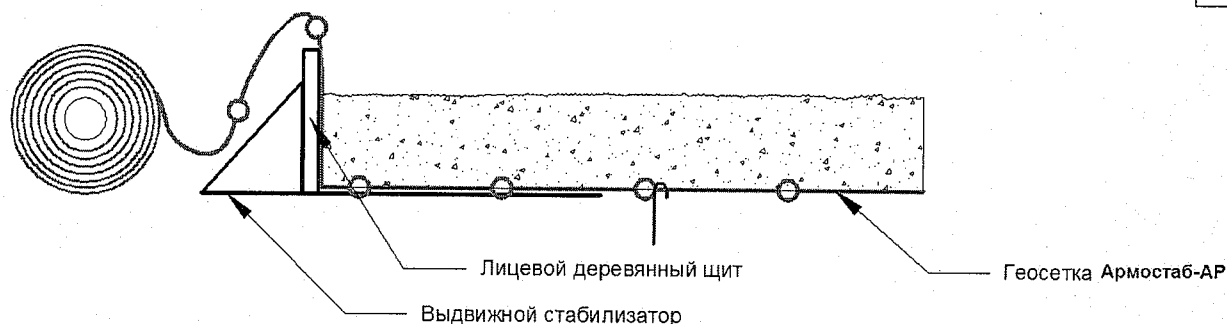
Рис. 5. Схема установки выдвигного стабилизатора и лицевого щита
