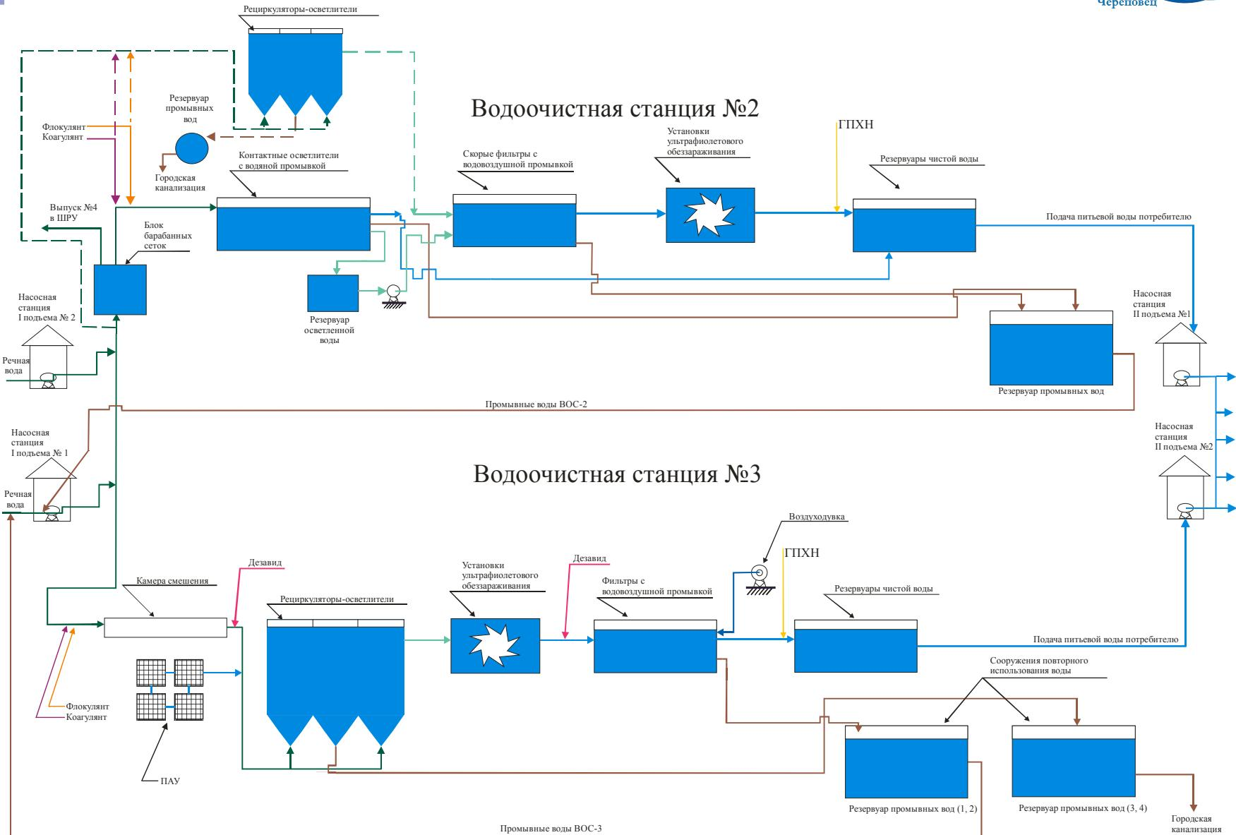
Рис. 1 Принципиальная схема водоподготовки на КВОС города Череповца
